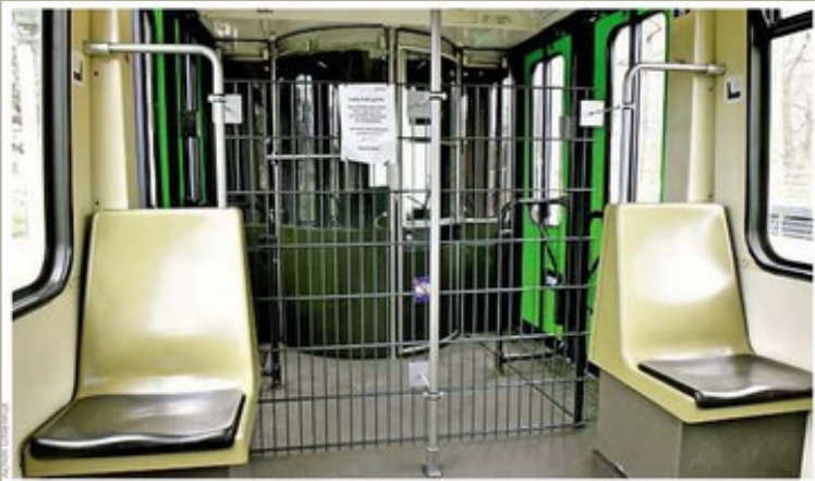
Die Hannoveraner Ustra hat in den Stadtbahnen des Typs TW5000 den Platz hinter der Fahrekabine mit Zaunelementen abgesperrt. In den Bussen ist der Bereich hinter dem Fahrer wie andernorts mit Flatterband abgesperrt.
